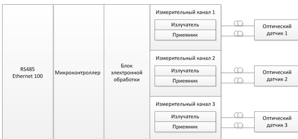
Рисунок 1 – Структурная схема оптического измерителя тока
