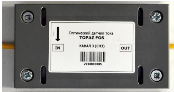
Рисунок А.2 – Внешний вид оптического датчика тока
